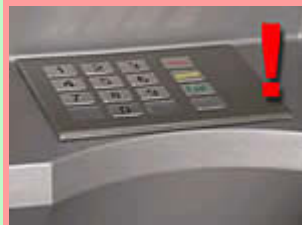
Klawiatura z założoną nakładką
