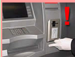
Okienko wrzutowe z założonym dodatkowym czytnikiem kart
